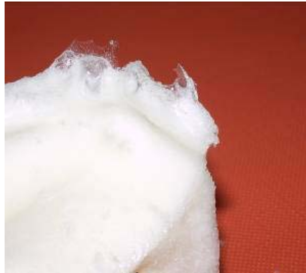
Φωτο 2. Το MEYCO® MP 350 αφροποιημένο μετά την αντίδραση με περίσσεια νερού.
