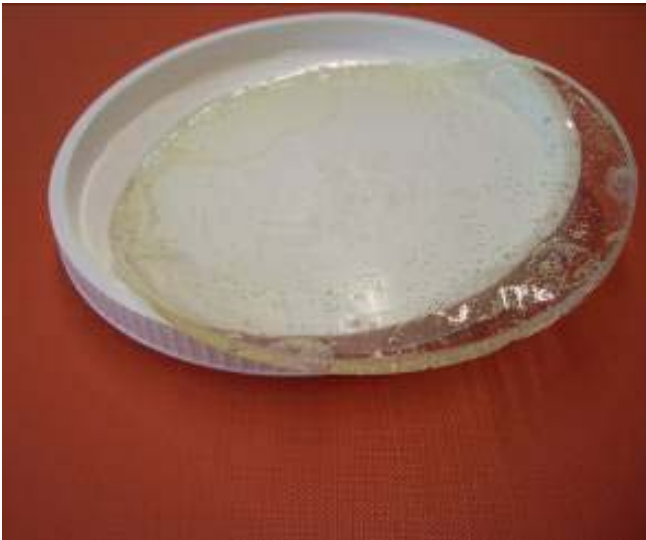
Φωτο1. Το MEYCO® MP 350 μετά την σκλήρυνση με περιβαλλοντική υγρασία ή υγρασία κατασκευής
